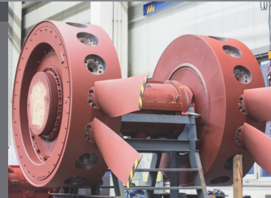
Los ventiladores funcionan a menudo en condiciones extremas, lo cual deja marcas. Para prevenir un fallo fatal y aumentar la durabilidad, TLT-Turbo puede reparar y reequipar su ventilador
