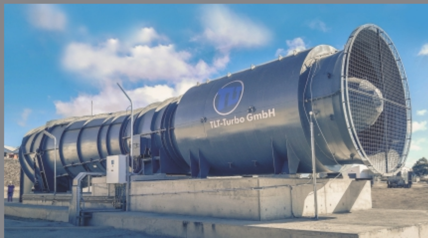
Ventilador de inyección modular estructurado listo para VOD con silenciador, muy cerca de las oficinas de la mina.
